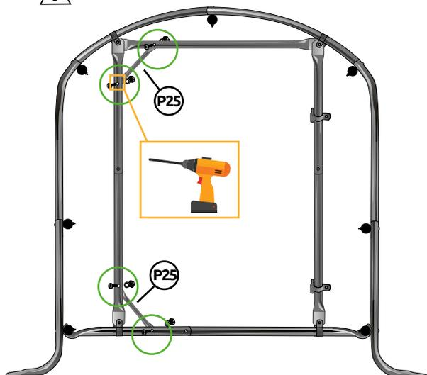
6- Fixer deux **Q25** avec deux brides  $\varnothing 32$  et les boulons  $\varnothing 6 \times 30$
