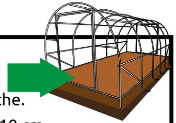
Il faut que la tranchée sur les longueurs de la serre soit à 10 cm minimum de l'armature.
