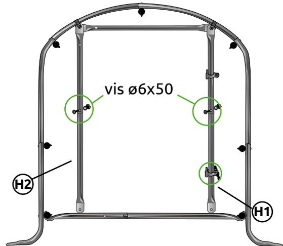
⚠️ Passer la deuxième charnière + boulon  $\varnothing 8 \times 30$  avant de joindre les deux tubes
