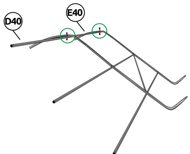
⚠ Ne pas serrer les boulons au début de l'assemblage.
