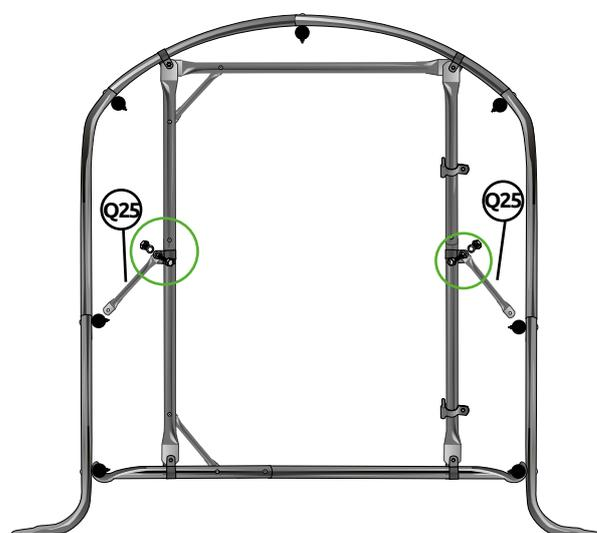
7- Fixer les deux autres extrémités des **Q25** avec deux brides  $\varnothing 40$  et les boulons  $\varnothing 6 \times 30$
